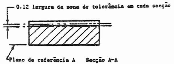
Figura 6.6 - Tolerância de perfil combinada com tolerância de paralelismo.
