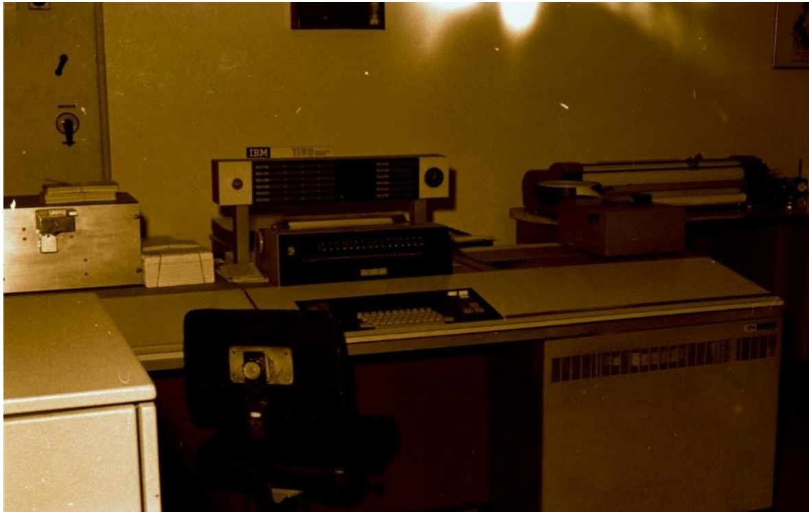
Unidade de processamento (CPU) do computador IBM 1130
