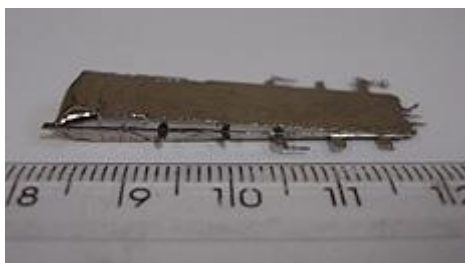
Liga obtida após o processo no forno e na coquilha de cobre
